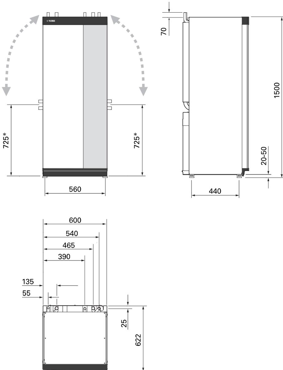
\* Dieses Maß gilt, wenn die Rohre für das Wärmequellenmedium (Seitenanschluss) einen Winkel von 90 aufweisen. Das Maß kann vertikal um ca. ±100 mm abweichen, da die Rohre für das Wärmequellenmedium teilweise als flexible Leitungen vorliegen.
