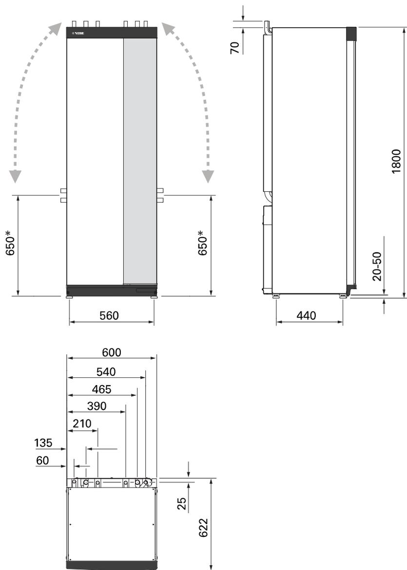
\* Dieses Maß gilt, wenn die Rohre für das Wärmequellenmedium (Seitenanschluss) einen Winkel von 90 aufweisen. Das Maß kann vertikal um ca. ±100 mm abweichen, da die Rohre für das Wärmequellenmedium teilweise als flexible Leitungen vorliegen.
